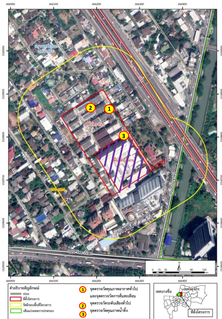
ภาพที่ 3-1 ตำแหน่งติดตั้งเครื่องมือตรวจวัดคุณภาพอากาศ เสียง ความสั่นสะเทือน และคุณภาพน้ำทิ้ง บริเวณพื้นที่ก่อสร้างโครงการ
